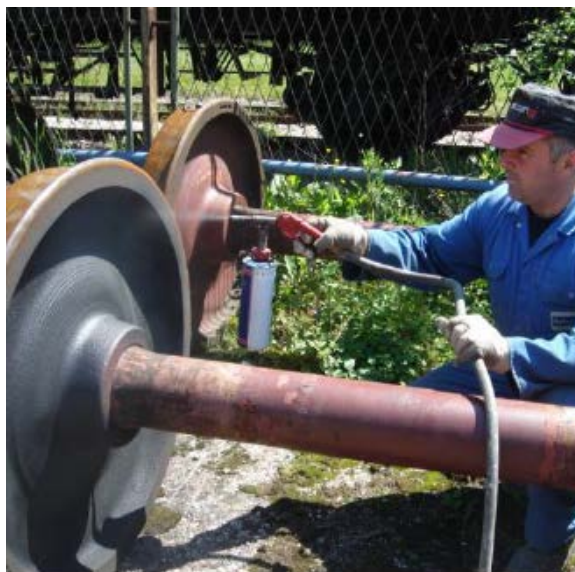
Slika. 4. 1. 3. 1. 2. Proces nanošenja dvokomponentne gumirajuće mase na disku točka
